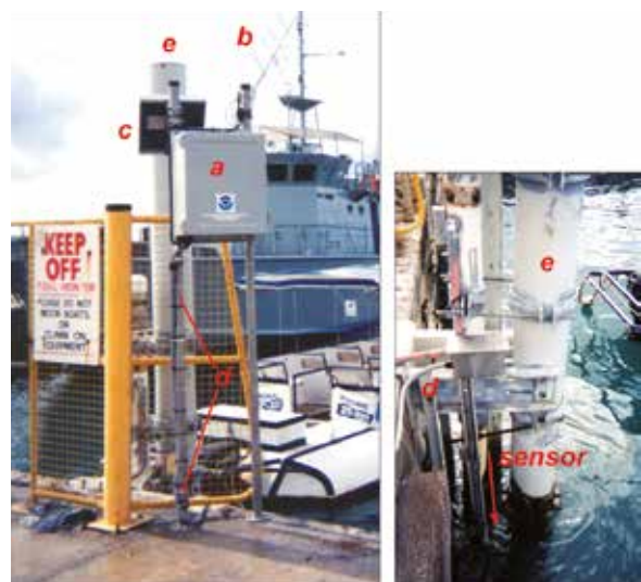
Estación del nivel del mar en Rarotonga, puerto Avarua en las islas Cook. El equipamiento electrónico de fibra de vidrio (a) antena, (b) panel solar fue instalado en un muelle. El conducto (d) que contiene los cables que conectan el sensor, ubicado a una profundidad de 1,5 m bajo el nivel de la bajamar, a la plataforma de colección de datos que contiene el equipamiento electrónico mostrado arriba, fue unido externamente a un tubo que contenía el sensor (e). Cortesía del Centro del Nivel del Mar de la Universidad de Hawái.
